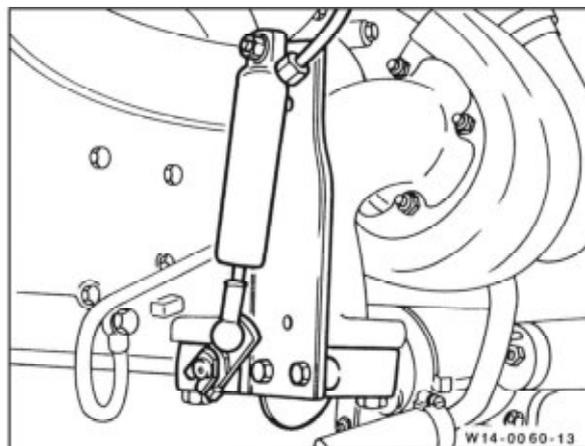
3 Ventil für Motorbremse betätigen und überprüfen, ob die Motorbremsklappe (13) ganz geschlossen ist.
